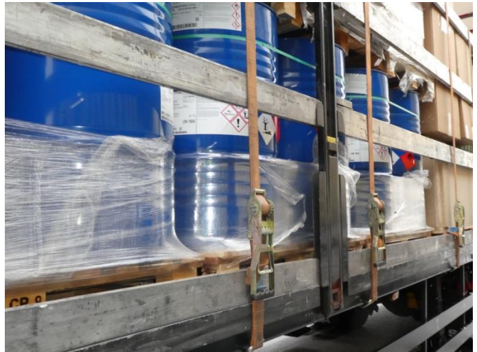
Die Sicherung der Ladung mit Spanngurten verhindert die Beschädigung der Versandstücke während dem Transport.
